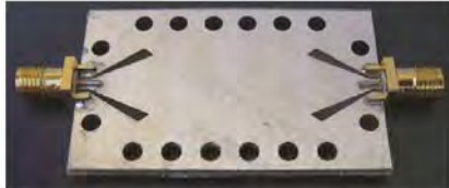
Structură originală de bandă foarte largă cu tranziții de la conectori coaxiale miniatură la circuite SIW.
