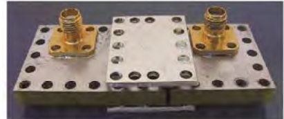
Structura originală de tip „flanșă-șoc” pentru interconectarea fără contact mecanic a componentelor SIW.
