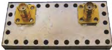
Structură originală cu tranziție directă de la structuri SIW la conectori coaxiale miniatură.
