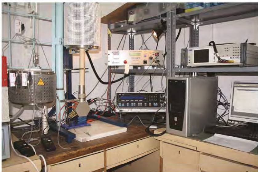
Ansamblul experimental folosit pentru testarea în condiții reale de lucru a micro SOFC prin spectroscopie de impedanță
