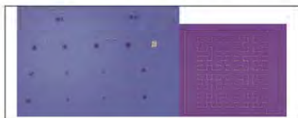
Fig. 1. Ștampilă fabricată cu cele 15 structuri, cu una din structuri în detaliu dimensiunea liniei fiind de 200 nm
