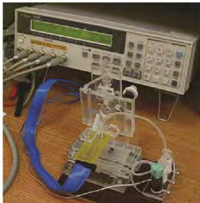
Fig.2b. Sistemul de măsură al senzorilor integrați în sistemul microfluidic și interfața grafică
